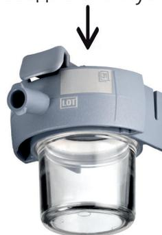
Роль одноразовой водяной ловушки D-Fend\* Pro заключается в отделении и изоляции воды в пробе газа, взятой из адаптера воздуховода. Она также действует как фильтр от пыли и бактерий/вирусов для защиты измерительных датчиков внутри газового модуля. Чтобы защитить модуль и его функции, следует заменять водяную ловушку всегда, когда на главном мониторе отображается сообщение «Замените водяную ловушку» или каждые два месяца, в зависимости от того, что наступит раньше.
