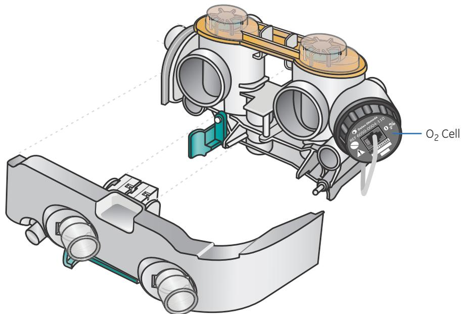
Figure 2.8 O<sub>2</sub> Sensor
