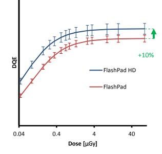
Fig. 1: DQE at Olp/mm vs dose of FlashPad and FlashPad HD detectors
